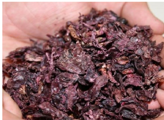
شکل ۱- تفاله انگور خشک شده با استفاده از سپراتور و دمای ۷۰ درجه سانتی‌گراد
