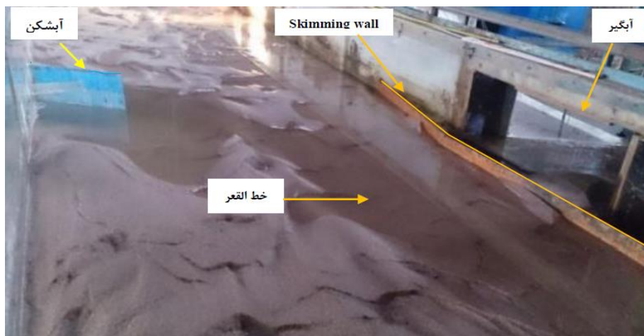
شکل ۴- نمایی از دیوار جداکننده و خط القعر ایجاد شده در جلوی آب‌گیر در مدل آزمایشگاهی (مرادی نژاد، ۱۳۹۶)
