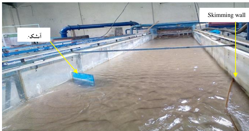
شکل ۶- نمای کلی فلوام آزمایشگاهی، دیوار جداکننده، آب شکن در حال انجام تحقیق (مرادی نژاد، ۱۳۹۶).
