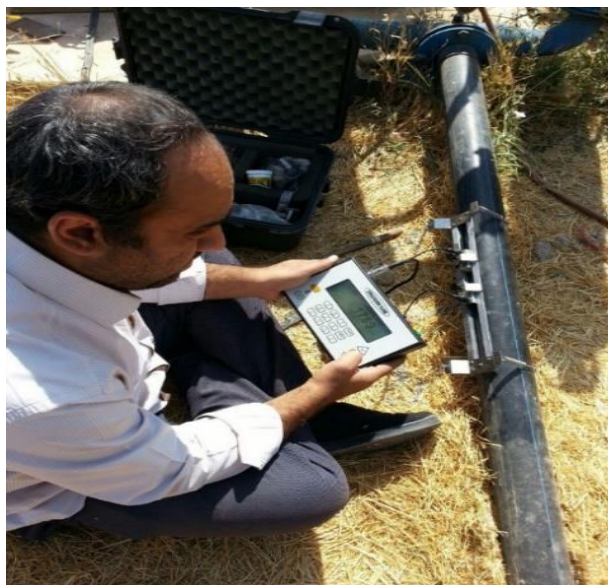
شکل ۲- اندازه‌گیری میدانی دبی ورودی به باغات با استفاده از دستگاه دبی سنج اولتراسونیک (یوسف گمرکچی، ۱۳۹۸)
