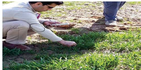
شکل ۴- اندازه‌گیری شوری خاک به وسیله دستگاه شوری‌سنج مزرعه‌ای
