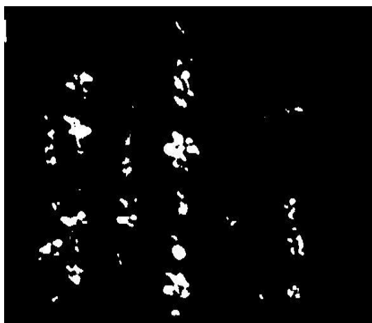
شکل ۶- تصویر حاصل از اعمال عملگرهای ریخت‌شناسی بر تصویر حاصل از مرحله قبل (شکل ۵)
