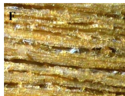
شکل ۷- تأثیر شرایط مختلف تیمار بخارگرمایی بر کیفیت سطح مماسی چوب صنوبر پس از پرداخت با بزرگنمایی ۴۰ برابر (کدهای مربوطه در جدول ۲ می‌باشد)
