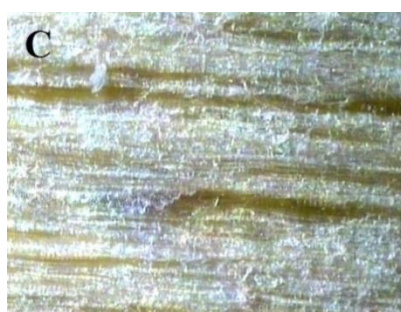
شکل ۷- تأثیر شرایط مختلف تیمار بخارگرمایی بر کیفیت سطح مماسی چوب صنوبر پس از پرداخت با بزرگنمایی ۴۰ برابر (کدهای مربوطه در جدول ۲ می‌باشد)
