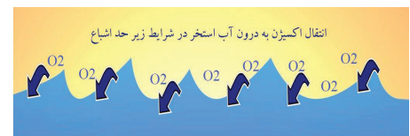
شکل ۱- انتقال اکسیژن از جو به درون ستون آب در شرایط DO پائین تر از حد اشباع
