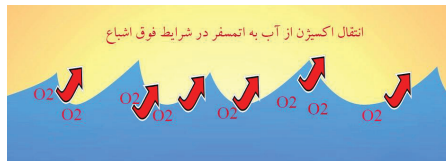
شکل ۳- انتشار اکسیژن از سطح آب به اتمسفر در وضعیت فوق اشباع
