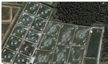
شکل ۵- چینش هواده ها در استخر پرورش بر اساس روش رایج
