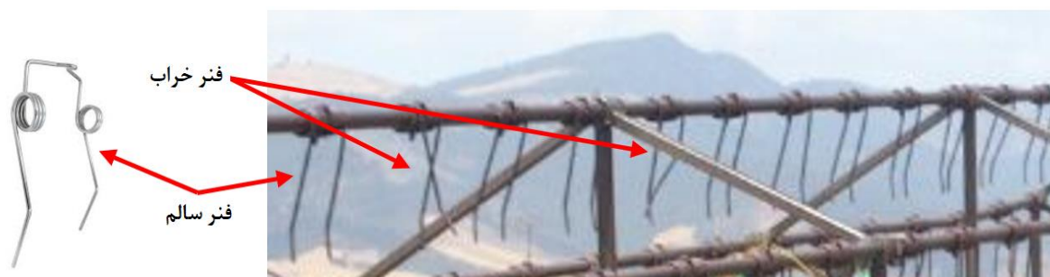
شکل ۲- فنرهای خراب و سالم موجود روی چرخ و فلک فتری
