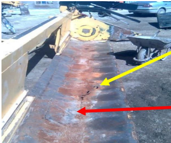
شکل ۸- خوردگی، پارگی و قسمت ترمیم شده هد برداشت
