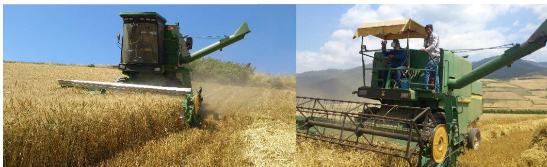
شکل ۹- کابین موجب راحتی راننده و افزایش تمرکز او بر برداشت شده و هدررفت گندم را کاهش می‌دهد
