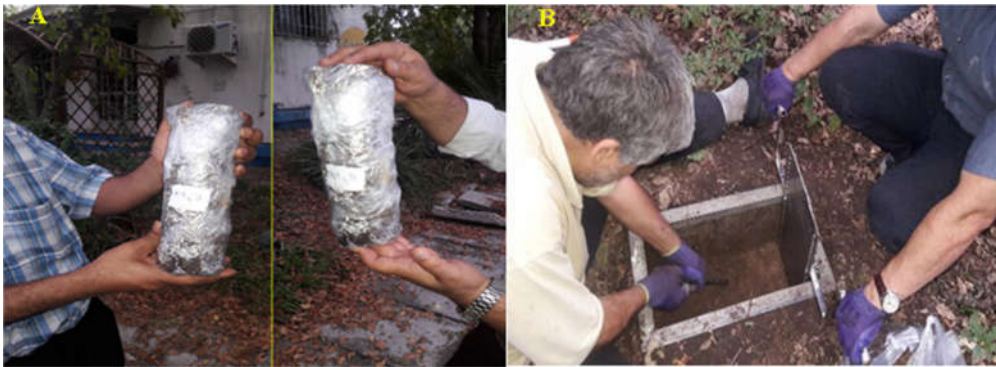
شکل ۲- (A) بازیابی مغزه خاک به‌صورت دست‌نخورده و (B) نمونه‌برداری از لایه‌های عمقی نمونه مرجع در حوضه نکارود
