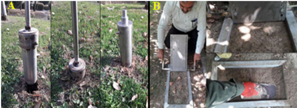
شکل ۱- (A) نمایش‌دهنده اجزاء و عملکرد مغزه گیر خاک دست‌نخورده و (B) مراحل استفاده از دستگاه Scraper Plate
