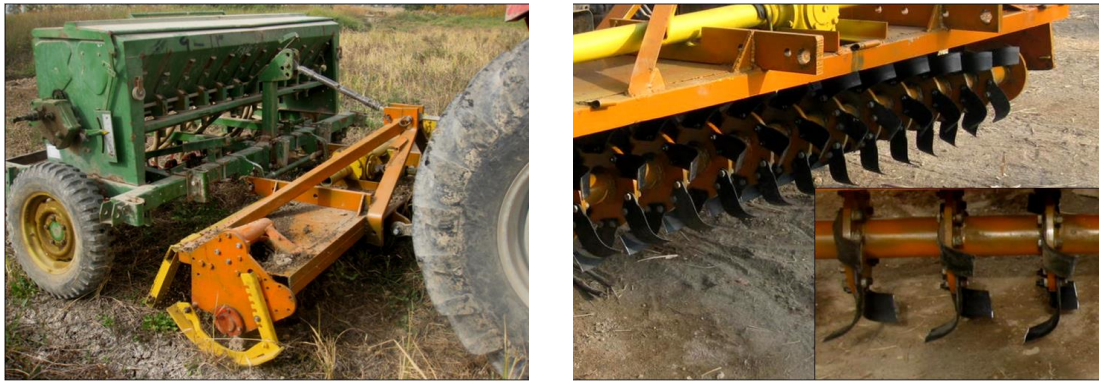
شکل ۱- نمایی از روتیواتور اصلاح شده و اتصال آن به خطی کار (Habibi Asl & Goosheh, 2017)
