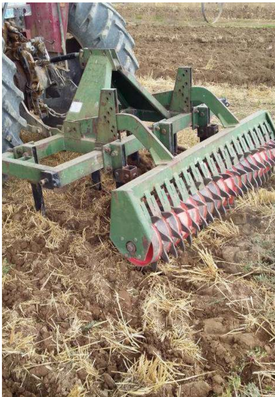
شکل ۳- استفاده از گاواهن قلمی مجهز به غلتک به منظور مخلوط کردن بقایا با خاک
