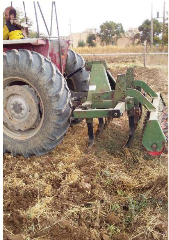
شکل ۳- استفاده از گاواهن قلمی مجهز به غلتک به منظور مخلوط کردن بقایا با خاک
