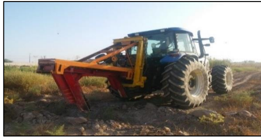
شکل ۲- نمای کلی از زیرشکن ارتعاش دورانی در حالت اتصال سه نقطه به تراکتور Fig. 2- Rotational vibration subsoiler in three-point coupling on tractor
