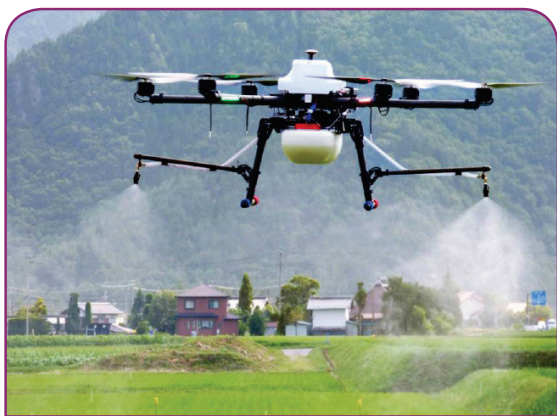
شکل ۳- پهپاد سمپاش در حال سمپاشی یک مزرعه
