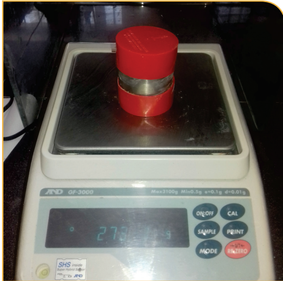
شکل ۳- اندازه‌گیری چگالی ظاهری به روش نمونه دست‌نخورده و توزین استوانه‌ها
