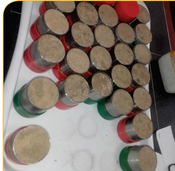
شکل ۳- اندازه‌گیری چگالی ظاهری به روش نمونه دست‌نخورده و توزین استوانه‌ها
