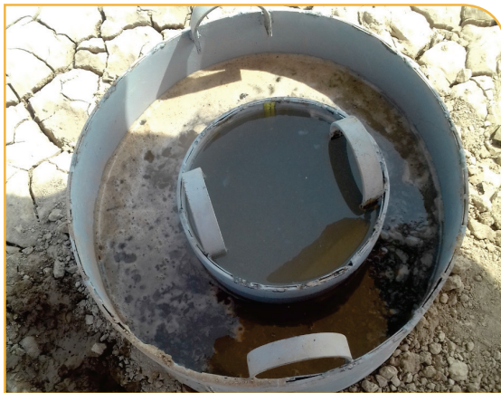
شکل ۴- اندازه‌گیری مقدار نفوذ آب به خاک به روش استوانه مضاعف
