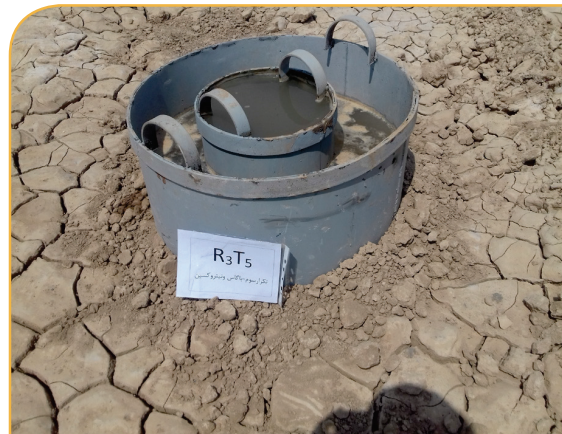
شکل ۴- اندازه‌گیری مقدار نفوذ آب به خاک به روش استوانه مضاعف
