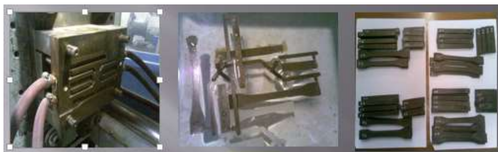
شکل ۴- نمونه‌های ساخته شده برای آزمون‌های خمش، کشش و ضربه
