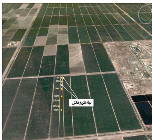
شکل ۴- نمایی شماتیک از کارگذاری لوله‌های پیزومتری (سمت راست) نسبت به سطح خاک (هاشور سبز رنگ) و عکس هوایی کارگذاری لوله‌های پیزومتری بین دو لوله زهکش (سمت چپ)
