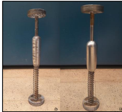
شکل ۲- اجزای سازنده شیر خودکار دبی. (a) شیر ۵ لیتر بر ثانیه و (b) شیر ۱۰ لیتر بر ثانیه
