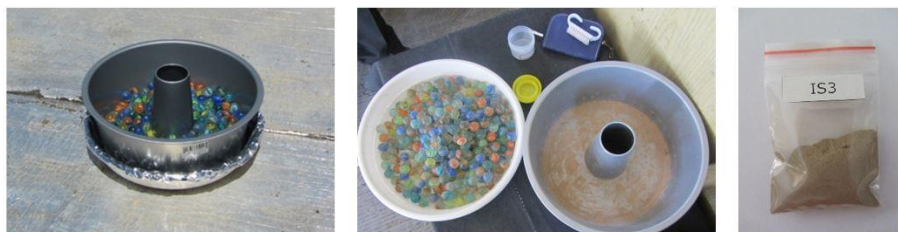
شکل ۲- ظروف تیل‌های جمع‌آوری‌کننده گردوغبار (Marble Dust collector, MDCO) و نحوه جمع‌آوری رسوب آن
