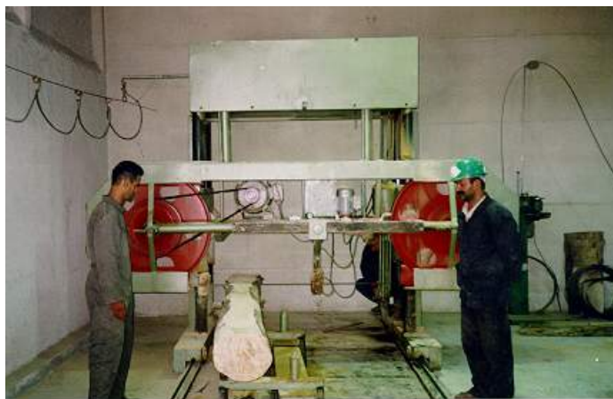
شکل شماره ۵ _ نمایی از ااره نواری افقی در حال کار
