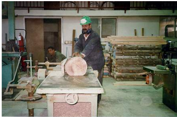
شکل شماره ۲ _ رندیدن یک سطح گرده بینه ( یک رو کردن) به کمک دستگاه کف رنده
