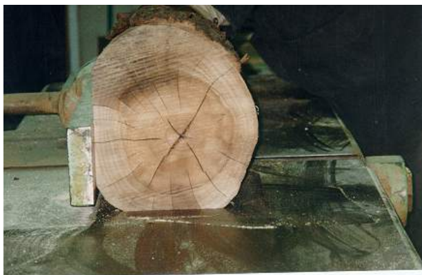
شکل شماره ۳_ رندیدن سطح دیگر گرده بینه (نر گرده بینه) به منظور بدست آوردن دو سطح عمود بر هم (یک رو یک نر کردن) به کمک دستگاه کف رنده
