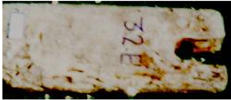
شکل شماره ۴- تخریب نمونه های آزمونی اکالیپتوس اشباع شده با سلکور
