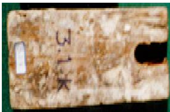
شکل شماره ۵- تخریب نمونه های آزمونی کرت اشباع شده با کربن دی‌اکسید
