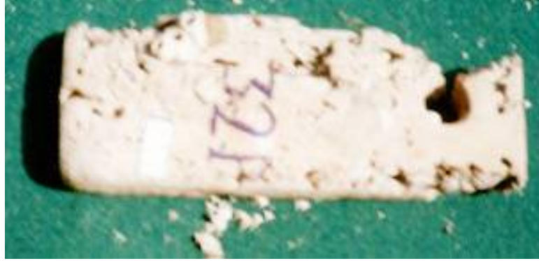
شکل شماره ۳- تخریب نمونه های آزمونی چنار اشباع شده با سلکور
