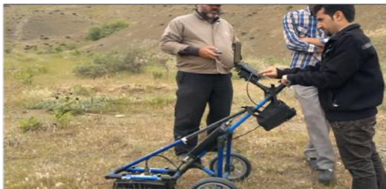
شکل ۳- برداشت داده با استفاده از دستگاه GPR
