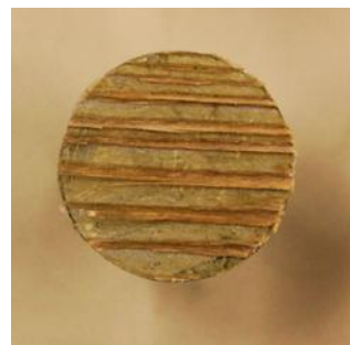
پوشش TPS بعد از هوازدهی
