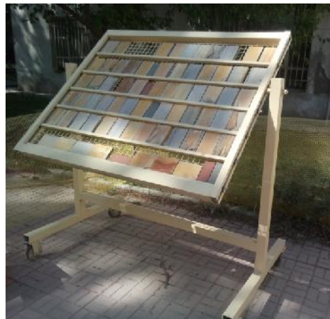
شکل ۲- سکوی هوازدگی مورد استفاده برای انجام آزمون هوازدگی طبیعی در فضای باز
