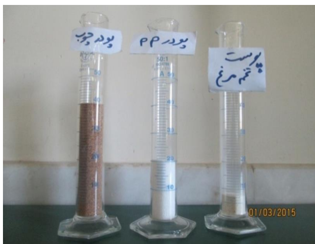
شکل ۱- تفاوت حجمی بین پودر پوست تخم مرغ، پودر پلی پروپیلن و پودر چوب
